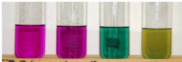
Abb. 2: Blindprobe, Acetoxy-, Alkoxy- Dichtstoff und Vergleichsprobe in basischer Kaliumpermanganat-Lösung (von links nach rechts)
