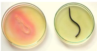
Abb. 1: Alkoxy-, Acetoxy- und Aminpolysiloxan-Fugenmassen und Universalindikator in geliertem Agar-agar (von links nach rechts)
