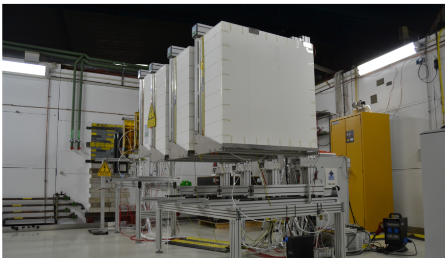
Abbildung 5.1: Ein Foto von den verwendeten 4 TRD-Prototypen mit Radiatoren vom Typ H.
