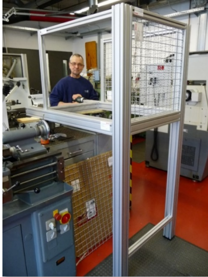
Abb. 26: Herr Billjött beim Bau eines Käfigs um die neuen Sicherheitsstandards für unter Hochspannung stehende Experimente zu erreichen.
