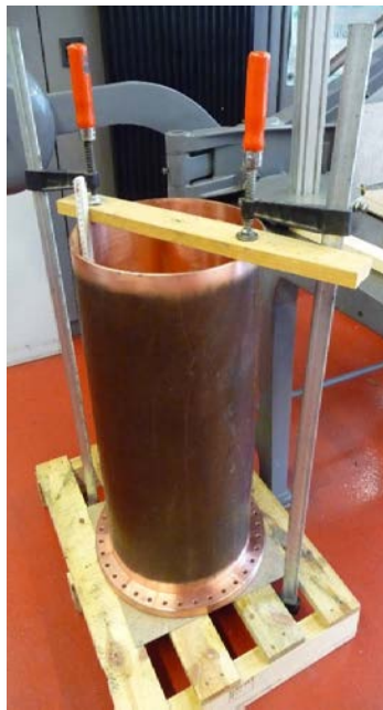
Abb. 27: Hier zu sehen die Fertigung eines Cu-Tanks mit den Maßen: D=440 \times 768 mm. Der Tank wurde dann im Vakuumlötofen des GSI-Technologielabors erfolgreich zusammengefügt (K. Dermati et al.).
