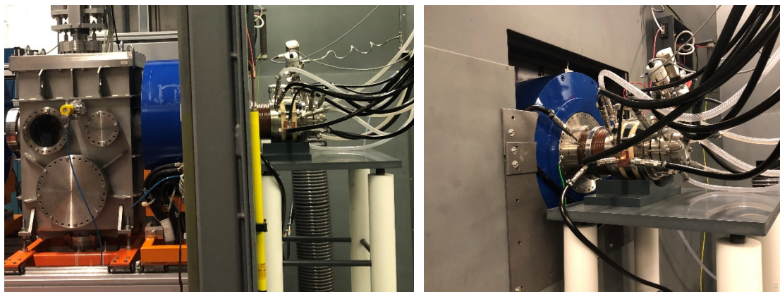
Abb. 6: Im linken Bild ist der gesamte Abschnitt dargestellt, von der CHORDIS-Quelle (rechts) über den Solenoiden (blau) zum ersten Diagnosetank. Das rechte Bild zeigt die CHORDIS – Quelle mit Versorgungsleitungen aus der Hochspannungsplattform von der Nähe.
