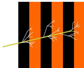
Abbildung 2.5.: Darstellung eines Schauers in einem Kalorimeter. Das Absorbptionsmaterial ist in schwarz und das Detektormaterial in orange dargestellt.
