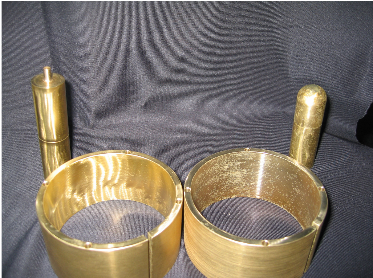
Abbildung 36: Photografie der Elektroden mit und ohne Erosion.
