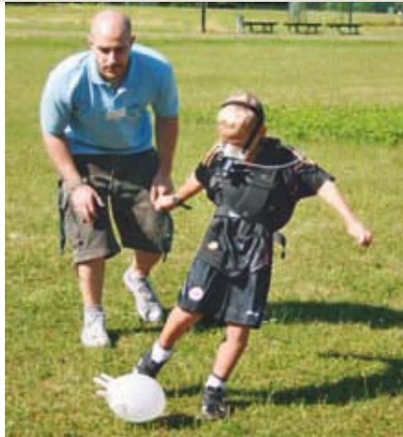
Die »Actiheart Validierung« ist ein neues Verfahren kombinierter Aktivitätsmessung bei Kindern. Das weniger als 10 Gramm wiegende Messgerät wird vor der Messung unter der Kleidung auf die Brust aufgeklebt und zeichnet Herzfrequenz und Beschleunigung über mehrere Wochen auf. Gurt und Maske sind Teil des Spirometriesystems zur Referenzmessung des Energieverbrauchs, also nur für die Validierung notwendig.
